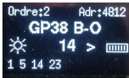
Lors d'un **court-circuit**, l'écran le signale ainsi: Il suffit de ré appuyer sur le bouton **GRIS** pour remettre en route le DCC si le court-circuit est réparé.
