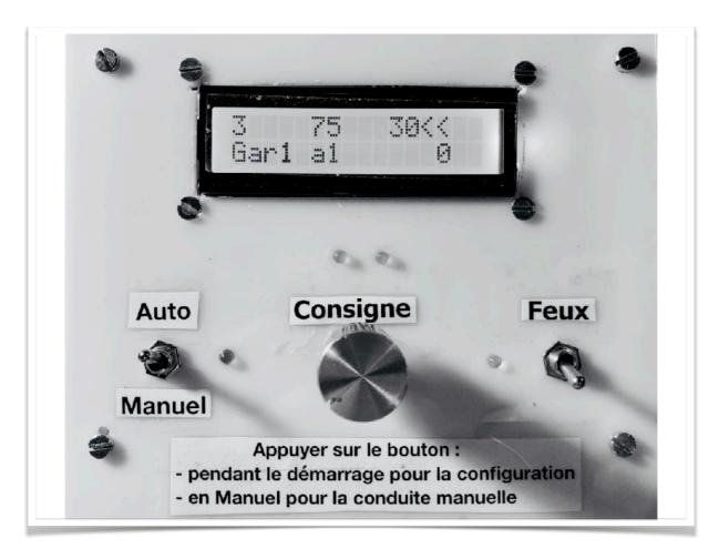
Ce Va-et-Vient, conçu par Dominique, est construit autour d'un Arduino Nano qui génère des trames DCC à l'aide de la bibliothèque DCCpp de Thierry. La partie puissance de la traction (appelée souvent « booster » est confiée à un LM18200 qui permet de fournir jusqu'à 3A de courant. La mesure de courant est faite par un Max471 qui protège le montage des court-circuits éventuels.
